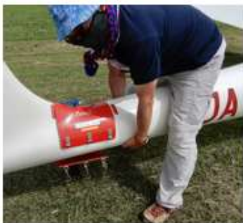
胴体を持ち上げてドーリー下部をセットする
