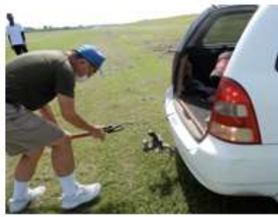
ウイングドーリーを外して牽引車に積み、台車を牽引車に接続する
