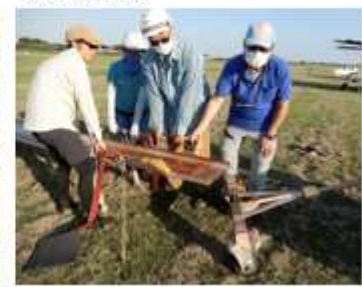
数人で台車を持ち上げトウバーを外す。トウバーは台車の前方に置く。
