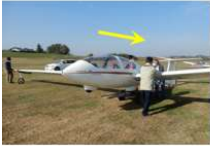
機体前後に人を配置し、台車中央をブレーキをかけながら後方へ押し出す
