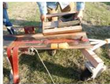
テールホルダーのロックピンを抜き、ホルダーを外す
