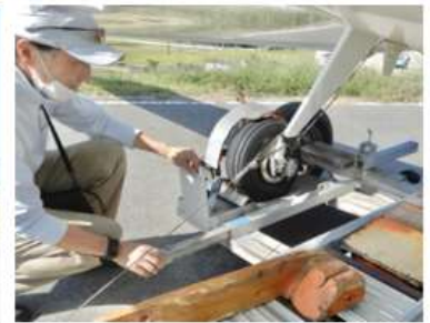
堤防上で停止し主翼の傾きを変える。翼端をホールドし左右のバーを抜く
