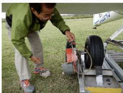
ロックピンはカバー側へさしておく
