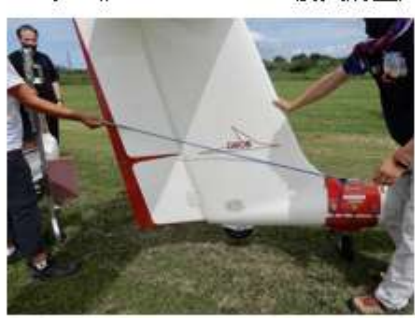
ラダーストッパーを尾翼の右側からかける(トウバーのラダー衝突防止)
