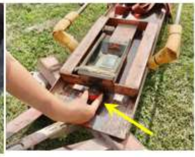
トウバーのピンにロックボルトをねじこむ
