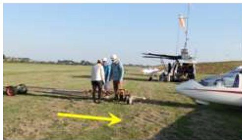
台車を機首の正面に向かい合わせる
