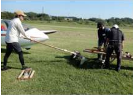
クッションを巻き付けてストラップを締める
