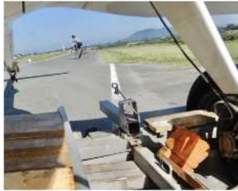
両車輪にチョークをかけ、機体を水平にする
