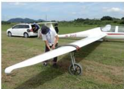
胴体を持ち上げてドーリー下部をセットする
