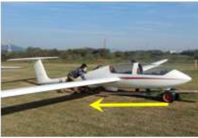
機体前後に人を配置し、台車中央をブレーキをかけながら後方へ押し出す
