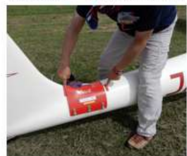
ラダーストッパーを尾翼の右側からかける(トウバーのラダー衝突防止)
