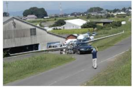
堤防上で停止し主翼の傾きを変える。翼端をホールドし左右のバーを抜く
