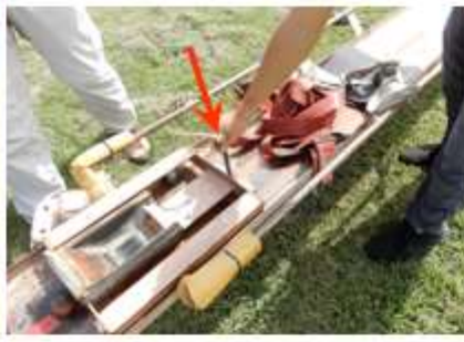
ウイングドーリーを外して牽引車に積み、台車を牽引車に接続する
